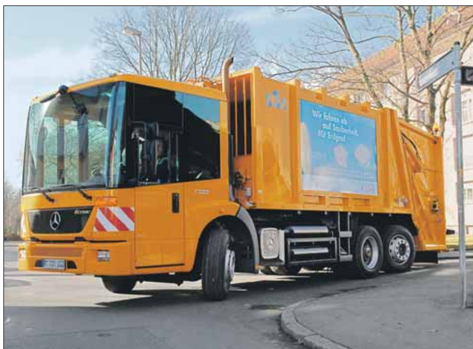
Auf Hybridbasis angetriebene Müllfahrzeuge verzeichnen gut 30 Prozent weniger CO 2 -Emissionen gegenüber konventionellen Müllfahrzeugen. ■
